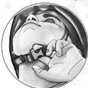
Pozostaw szczelinę na grubość jednego palca
